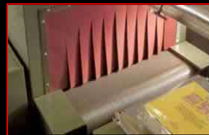
Cortinas de túneles de empaque
